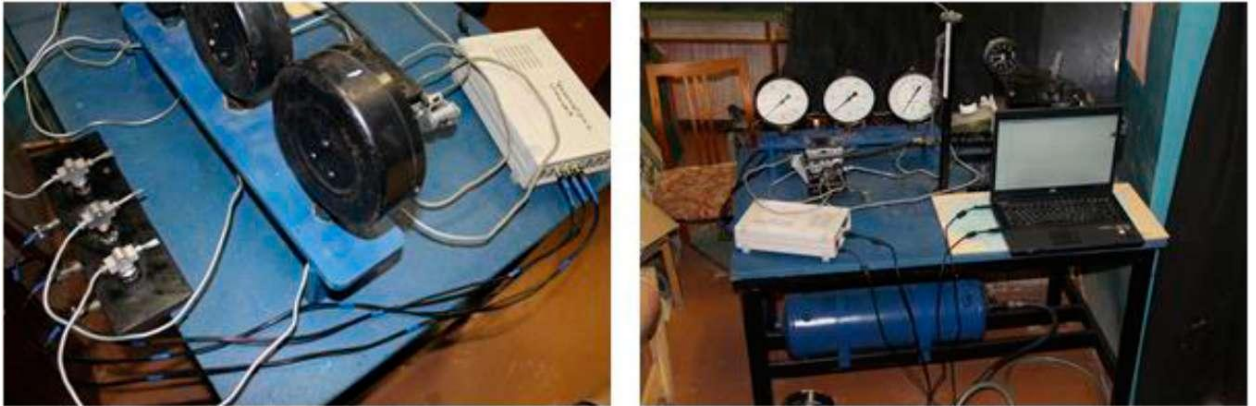
Рис. 2 - Проверка регулятора тормозных сил ВА3 на стенде
